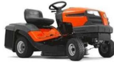
Motor B&S 21R700 Potencia 12.5 HP Cilindrada 344CC Transmisión Automática Velocidad máxima avance 6.7 km/h Numero cuchillas 1 Niveles corte 6 Ancho corte 30"/77cm Peso 190Kg Cap combustible 5.7L"
