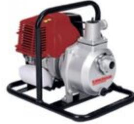
Cilindrada: 31cc Diámetro de descarga: 1" Capacidad máxima de descarga: 170 L /min Altura total de descarga: 22m Altura de succión: 2m Capacidad depósito de combustible: 850 ml Tipo de bomba: Autocebante Peso: 9.5 kg
